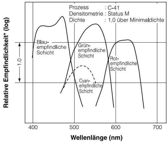
\* Die Empfindlichkeit entspricht dem Kehrwert der Bestrahlung ( $J/m^2$ ), die erforderlich ist, um eine vorgegebene Dichte zu erreichen.
