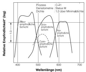
Die Empfindichkeit entspricht dem Kehrwert der Bestrahlung (J/m²), die erforderlich ist, um eine vorgegebene Dichte zu erreichen.
