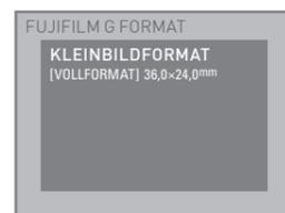
**Kleinbildformat-Modus\*** In diesem Modus wird nur eine 36,0 × 24,0 mm (30,5 MP) große Fläche in der Sensormitte zur Aufnahme verwendet (JPEG und RAW). Bei Verwendung von Adaptern für Kleinbildformat-Objektive lässt sich die Bildgröße mithilfe der Funktion an den kleineren Bildkreis anpassen.
