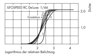
Die folgenden Schwärzungskurven gelten für ILFORD ILFOSPEED RC De Luxe mit der Oberfläche halbmatt in den Gradationen 1 bis 4 bei Schalenverarbeitung in ILFOSPEED-Entwickler in Verdünnung 1+9 und 1 Minute Entwicklungszeit bei 20°C.
