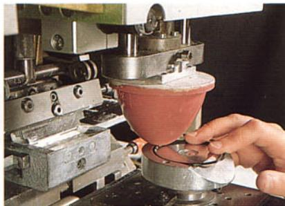
Die Bedruckung einzelner Fassungssteile erfolgt im Tampondruckverfahren.
