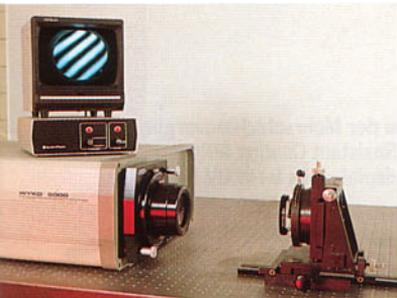
Ein mit Laserstrahl arbeitendes Interferometer erlaubt die Prüfung des Filterglases auf Ebenheit und Planparallelität.
