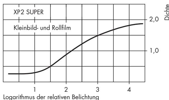
Das Diagramm zeigt die beim Vergrößern wirksame Schwärzungskurve des im C-41-Standardprozeß entwickelten XP2-SUPER-Kleinbild- und Rollfilms. Der XP2-Planfilm hat einen im rechten Teil geringfügig steileren Kurvenverlauf mit einer daraus resultierenden knapp 0,5 Einheiten höheren Maximaldichte.
